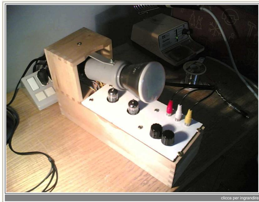
Il circuito di polarizzazione del tubo proposto nel mio tutorial <http://www.grix.it/viewer.php?page=7829> prevede il catodo del DG7/32 a massa e la regolazione della luminosità del fascio controllata dal potenziale negativo della griglia g1.
